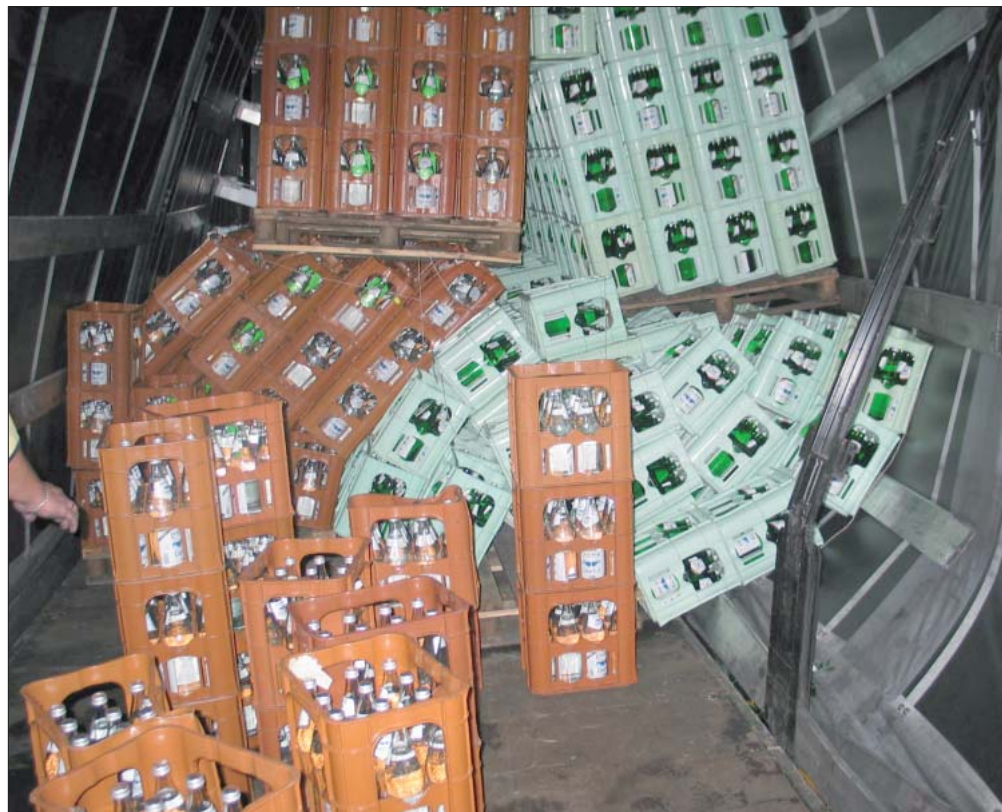
Ungesicherte Ladung auf nicht zertifiziertem Trailer. Beim Durchfahren einer Rechtskurve mit normaler Geschwindigkeit kippte die ungesicherte Ladung in die Plane – Ende der Auslieferung.
