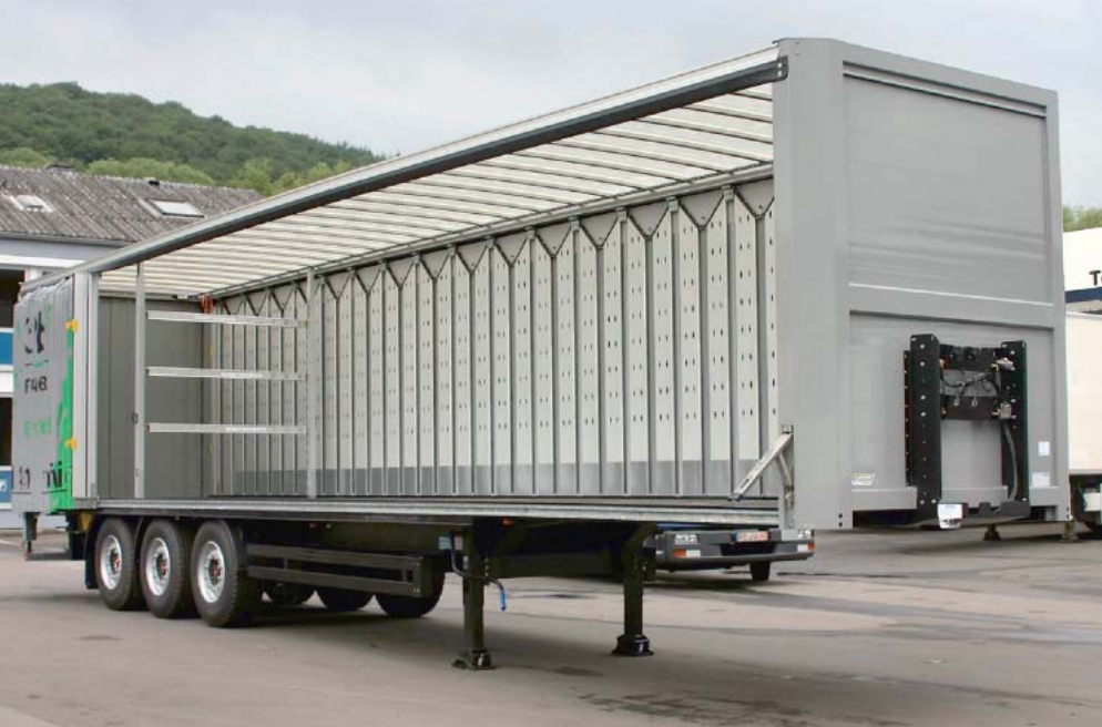
Ortens SafeServer hat die DEKRA für die Getränkelogistik nach VDI 2.700 zertifiziert. Sehr gut erkennbar ist die integrierte rückwärtige Ladungssicherung.
