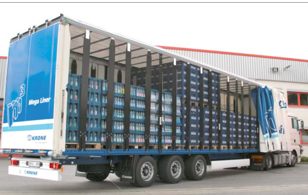
Krones MegaLiner, ebenfalls ein zertifiziertes Getränkefahrzeug, optimal ausgerüstet für den Transport gemischter Ladung. (Foto: Eggenhofer)
